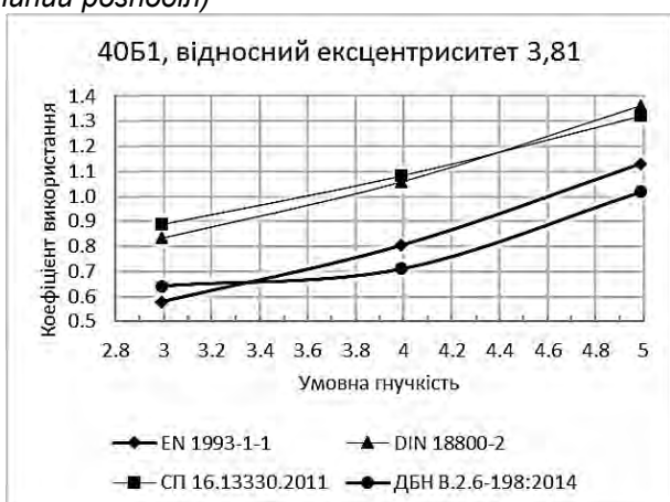
Рис. 1. Залежність коефіцієнта використання від відносного ексцентриситету (а - трикутний розподіл; б - постійний розподіл)
