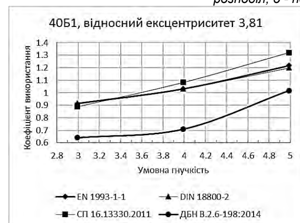
Рис. 1. Залежність коефіцієнта використання від відносного ексцентриситету (а - трикутний розподіл; б - постійний розподіл)
