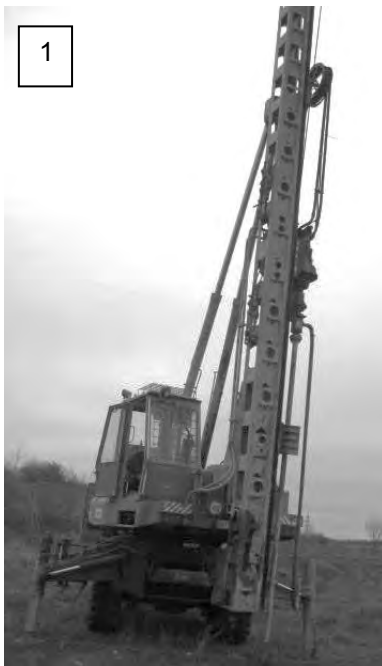
Рис. 1. Комплект обладнання для влаштування ґрунто-цементних елементів за бурозмішувальною технологією
